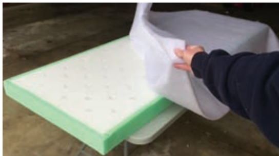
شکل ۶۰- پوشش اسفنج با یک لایه گان
