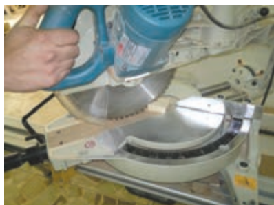
شکل ۲۰- برش فارسی یا ۴۵ درجه باره فارسی بر
