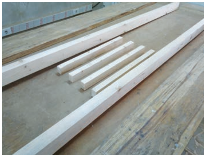
شکل ۳۹- قطعات پاراوان (۲ قید طولی و ۴ قید عرضی)
