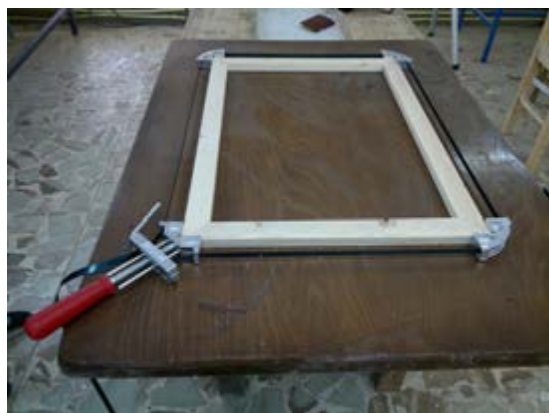
شکل ۳۰- بستن قاب با استفاده از گیره تسمه‌ای
