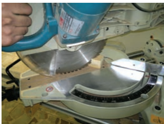
شکل ۲۲- بریدن دو قطعه با هم
