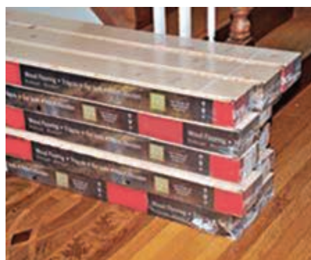
شکل ۲۶ و ۲۷- نحوه قرار دادن درست جعبه‌های لمینت
