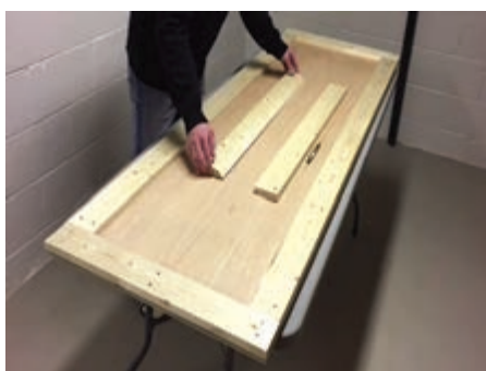
شکل ۴۲- نوارهای چوبی لبه تخته با فیتینگ های نصب
