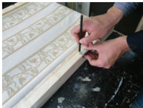
شکل ۶۸- خط کشی با استفاده از لولا
