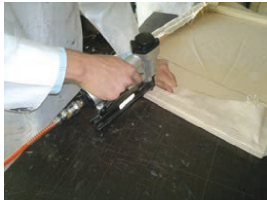
شکل ۳۷- منگنه زدن ضلع آخر قاب
