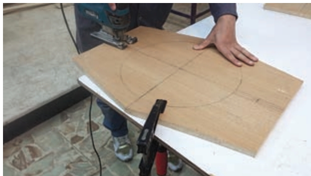
شکل ۴۹- محکم بستن قطعه کار
