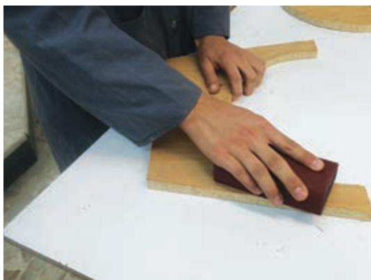
شکل ۶۶- پرداخت کاری با تخته سنباده
