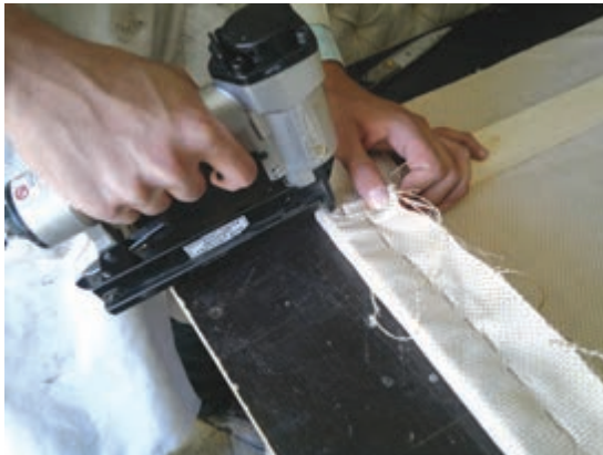
شکل ۳۴- منگنه زدن یک گوشه دیگر از قاب
