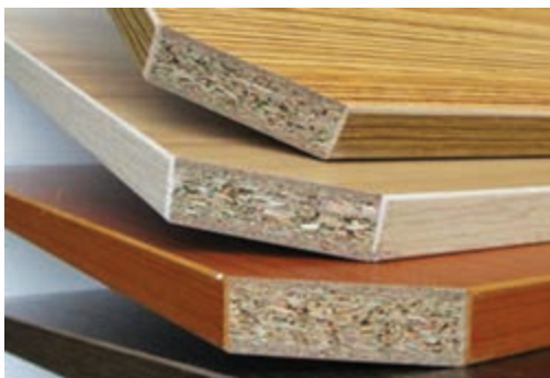
شکل ۱۴- تخته خرده چوب با روکش مصنوعی
