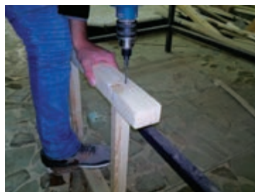
شکل ۵۳- سوراخ کاری با مته خزینه دار
