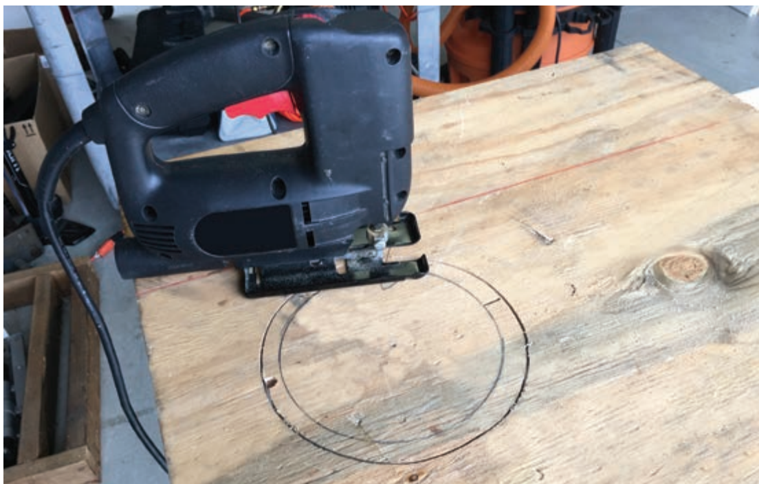
شکل ۵۱- برش داخل قطعه کار
