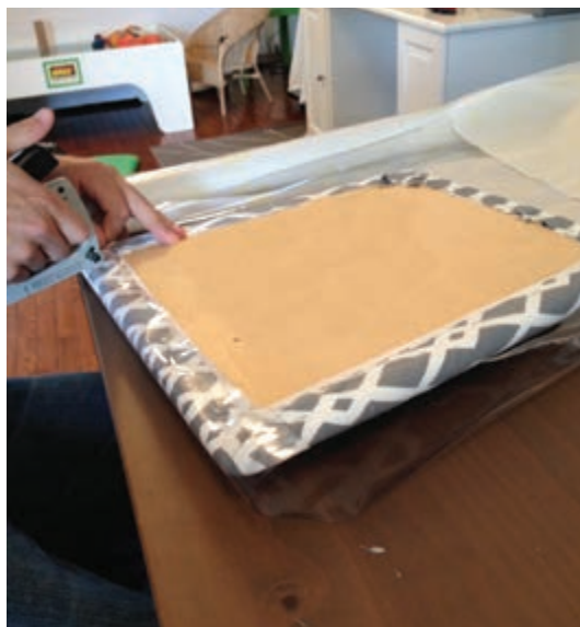
شکل ۷۸- رویه کوبی روی تخته
