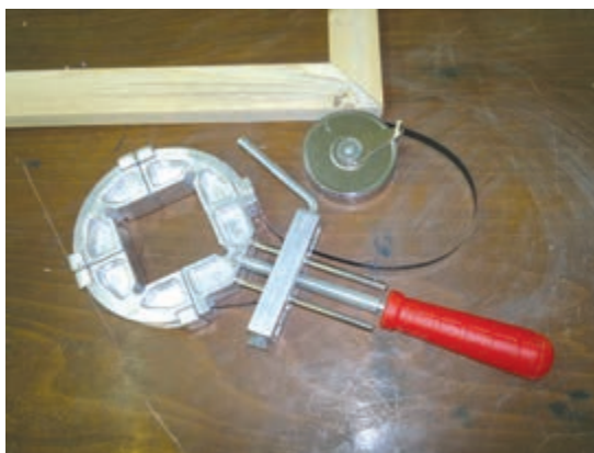
شکل ۲۹- گیره تسمه‌ای مخصوص قاب
