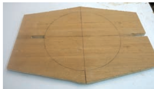
شکل ۶۰- شکاف پایه‌ها به صورت برش خورده
