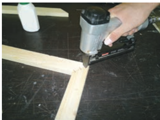
شکل ۲۶-زدن ۲ یا ۳ منگنه در گوشه قاب
