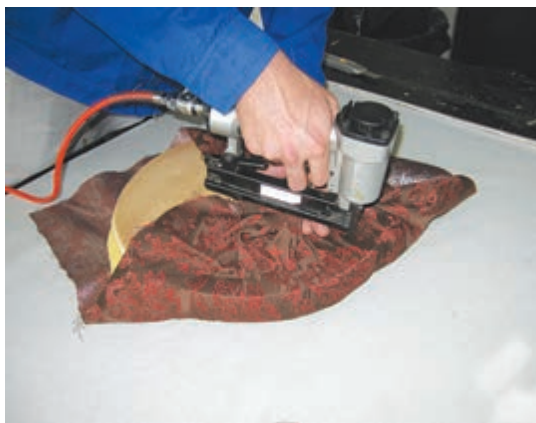
شکل ۱۱۷- منگنه زدن چهارطرف و ثابت کردن پارچه
