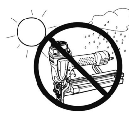
شکل ۱۰۷- محافظت شیلنگ هوا از بارش برف و باران و تابش خورشید
