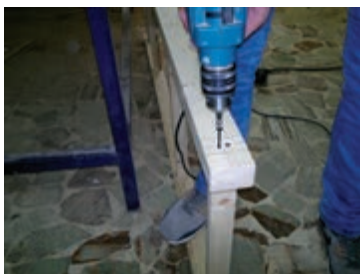
شکل ۵۷- بستن پیچ با دریل
