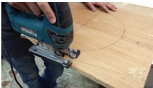
شکل ۵۳- برش قسمت مورب دیگر پایه‌ها
