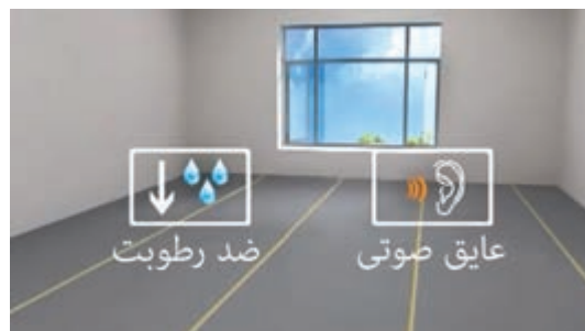
شکل ۲۰ تا ۲۳ - مراحل اجرای فوم روی کف (فاصله بین فوم‌ها با چسب کاغذی پوشیده شود)
