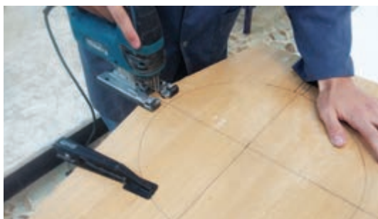
شکل ۵۶- برشکاری از محل اتصال پایه‌ها
