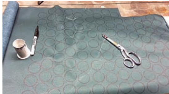
شکل ۶۴- خط‌کشی برای دکمه روی چرم مصنوعی
