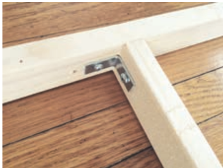
شکل ۲۱- اتصال با بست گونیايي
