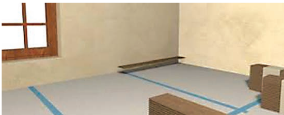
شکل ۲۴ - پوشش کامل کف با فوم صدا گیر
