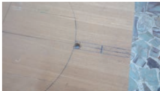
شکل ۵۸- سوراخ کاری برای قرار گرفتن تیغه
