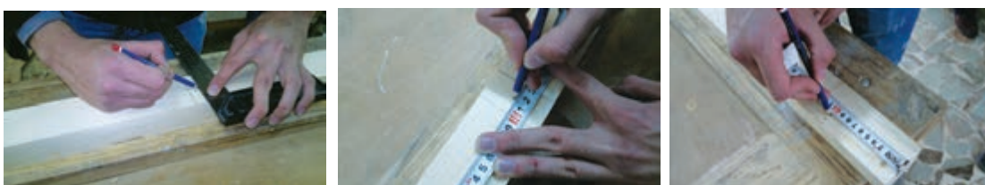
شکل ۴۶- اندازه‌گیری بین دو خط و خط‌کشی خط میانی
