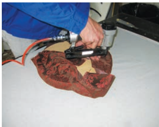
شکل ۱۱۶- منگنه زدن دو طرف پارچه در مقابل هم
