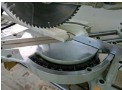
شکل ۲۱- بریدن یک قطعه هم اندازه قطعه دیگر
