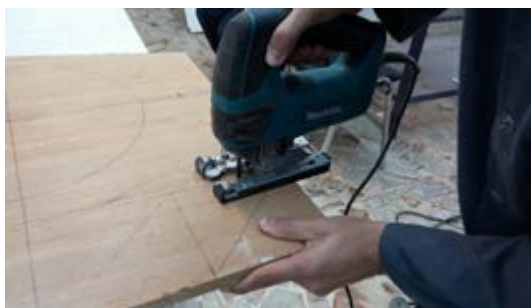
شکل ۵۴- بریدن قطعه کناری تشکیل دهنده نبشی‌ها
